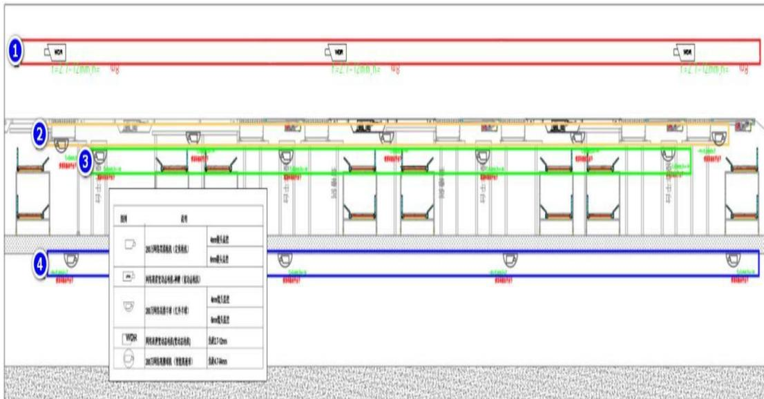
图12 快件分拣矩阵区立面监控布局示意图
