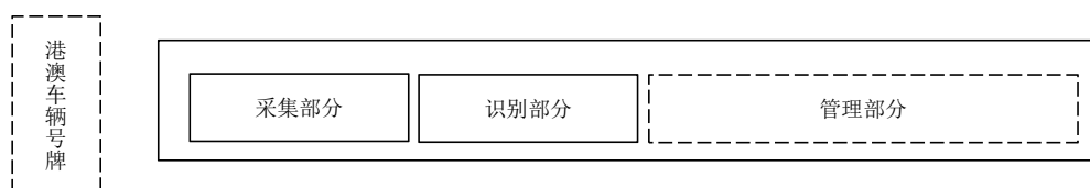
图1 港澳车辆号牌信息采集与识别系统组成
